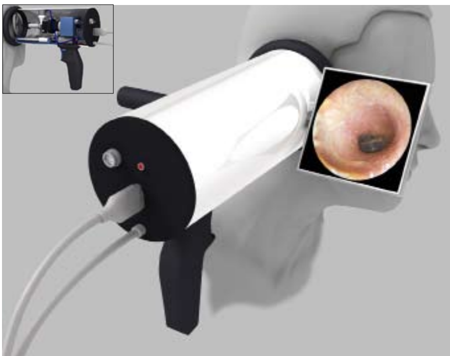
Scannern tar på ett par sekunder ett 60-tal bilder som omvandlas till en tredimensionell bild av örat.
